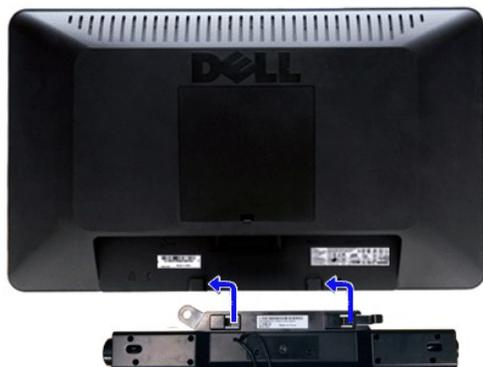
1. Operando sul retro del monitor, collegare la Soundbar allineando i due slot alle due alette lungo il lato posteriore del monitor.
